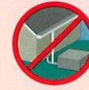
**Ne connectez PAS** les gouttières, les égouts de sous-sol, ni les drains de surface au réseau d'égouts. L'eau supplémentaire pourrait faire refouler les égouts et causer des dégâts d'eau dans votre sous-sol si vous n'êtes pas équipé d'un dispositif antirefoulement.
