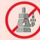
**Ne connectez PAS** la pompe du puisard du sous-sol au système de fosse septique.
